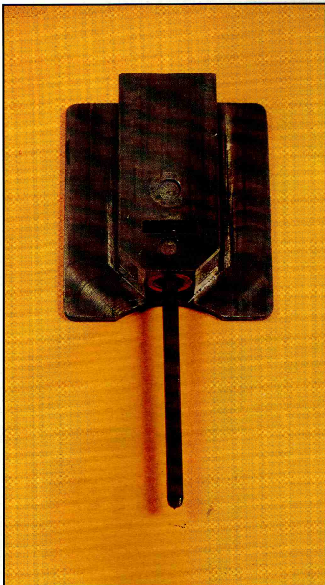
La valvola gas, piatta, conserva due alette di guida che scorrono in due sottili fessure nel corpo carburatore.
